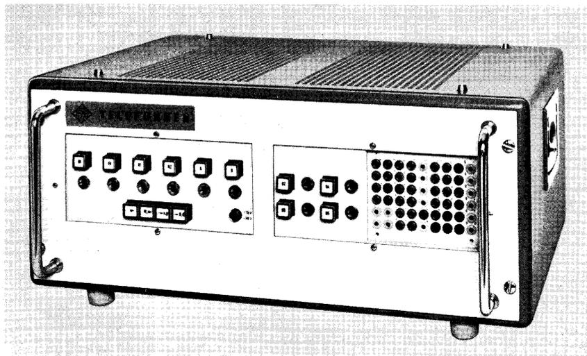
Für die Verwendung mit Tischanalogrechnern wird der Einschub in ein Gehäuse\* eingebaut und ist über ein Parallelschaltkabel, das Querverbindungsleitungen zur Übergabe der Rechen-spannungen sowie Steuerleitungen enthält, mit dem Rechner zu verbinden. Außerdem ist der Resolver an das Netz anzuschließen.
